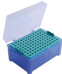
Diese leeren Pipettenspitzenboxen von Moonlab® sind für die Moonlab® Pipettenspitzen 0,2-1000 µl geeignet. Die Abstände zwischen den Öffnungen gewährleisten eine einfache Nutzung der Box in Verbindung mit Mehrkanalpipetten. Die Boxen sind platzsparend übereinander stapelbar. Mit transparentem Deckel für die bessere Sicht. Jede Pipettenspitzenbox enthält 96 (8 x 12) Steckplätze.
