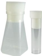
Aufzuchtgefäße aus hochwertigem klarem Polystyrol für die einfache Sichtkontrolle. Diese Einmalgefäße sind die günstige Alternative zu Glasgefäßen. Maße: 28,5x95 mm. Erhältlich im Beutel und im Rack.
