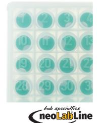
Deckel und Unterteil sind so konstruiert, dass der Deckel immer eindeutig orientiert aufgelegt wird - Position Lock. Die neoBox 81 plus ist aus widerstandsfähigem Polypropylen gefertigt und von -90°C bis +121°C temperaturbeständig und autoklavierbar.
